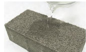
吸水実験。瞬時に吸収された水はスポンジのようにブロック内部に浸透
