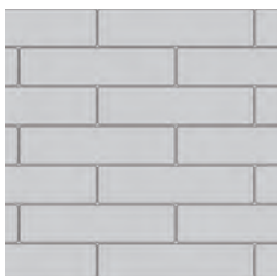
ブリック張り(ウマ張り)
