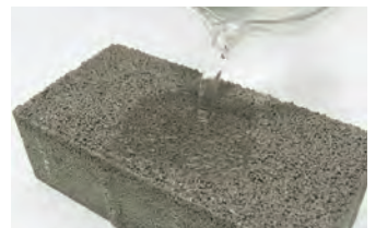
吸水実験。瞬時に吸収された水はスポンジのようにブロック内部に浸透
