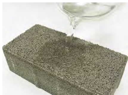
吸水実験。ピーカーから注がれた水を瞬時に吸い込み、スポンジのようにブロック内部に浸透させていきます。
