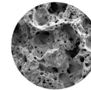
グリーンビズ基盤2000倍拡大写真(左)。スポンジのような超微多孔構造を持つ素材が水を蓄えることで、超保水性を発揮。
