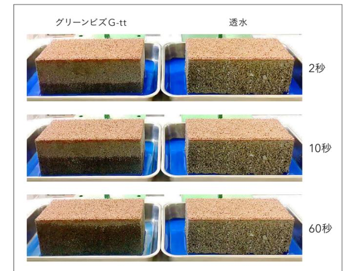
着色した水を張ったバットにグリーンビズG-tt(左)と透水製品(右)を置いたもの。グリーンビズG-ttは配置直後に吸い上げを始め、60秒後には表面近くまで浸透しています。
