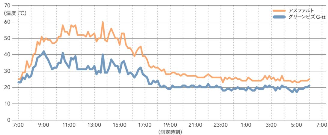
グリーンビズG-ttとアスファルト舗装の表面温度推移グラフ。外気温が上がる日中で特に温度差が大きくなっており、グリーンビズG-tt舗装は約20℃の低減効果を発揮している。
