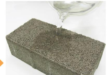
吸水実験。ピーカーから注がれた水を瞬時に吸い込み、スポンジのようにブロック内部に浸透させていきます。
